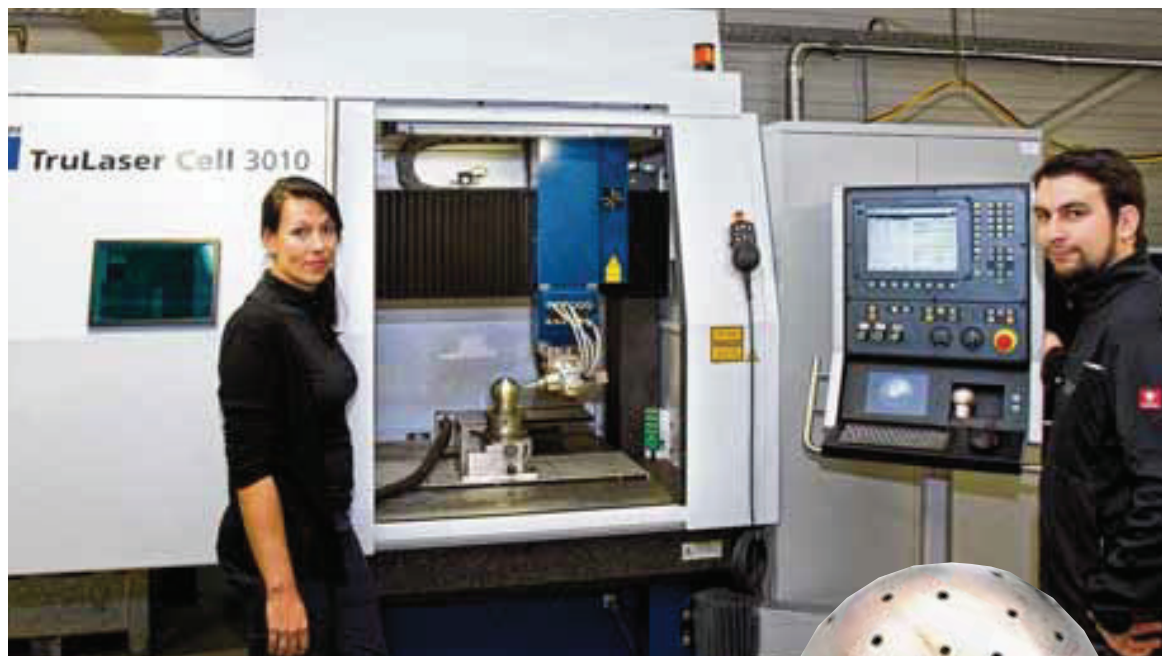
Im 3D-Laserzentrum der Firmengruppe Burkhard können auch komplexe Produkte wie der Sprühkopf (rechts) gefertigt und bearbeitet werden. Foto: Mathias Wild
